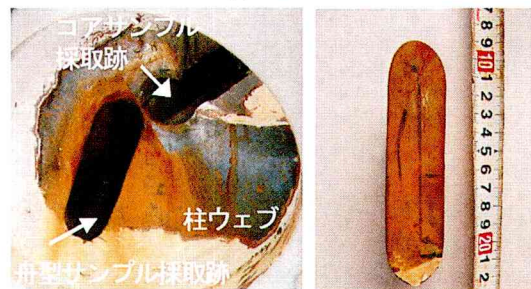
(b) 採取後の柱ウェブ面 (c) 舟型サンプル
