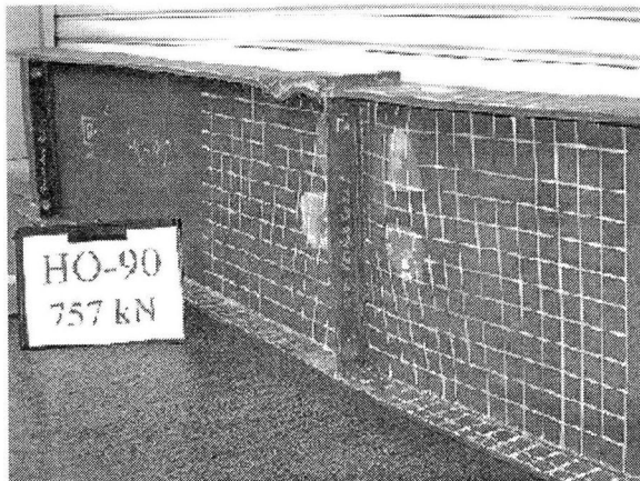
写真-2 座屈後供試体(HO90)
