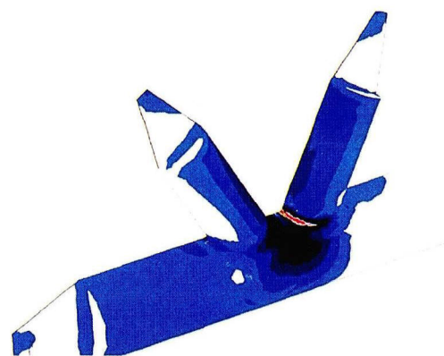
K-2B-2（鋼－コンクリート一部剥離）
