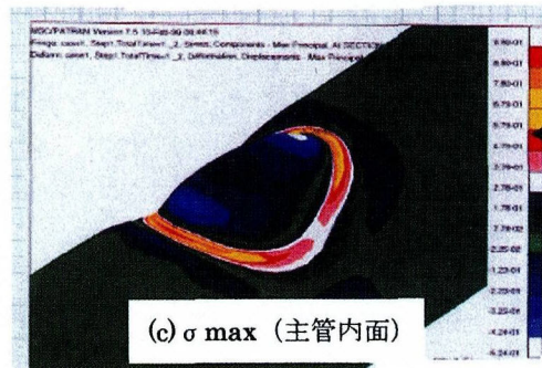
図 14 溶接による残留応力のモード
