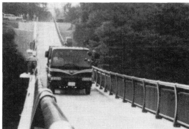
写真－２ 46kN 車による車両走行実験状況
