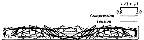
図-10 浮体構造物の主応力、縁応力、動水圧分布 ( dk_T=0.200 , 図-9(a) と対応)
