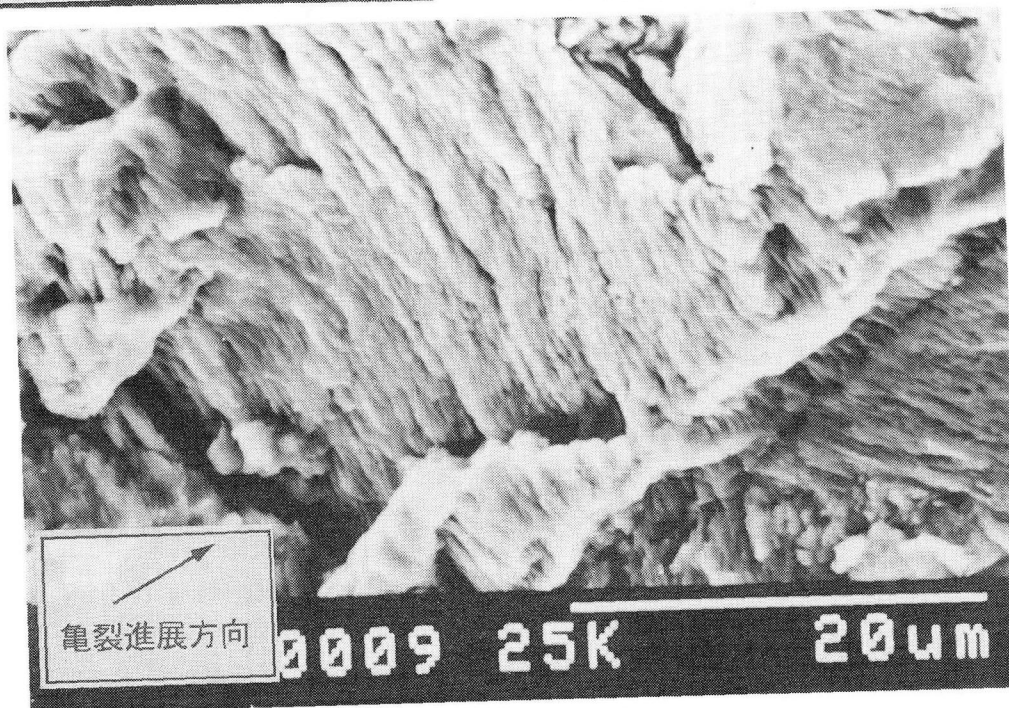
写真-7 き裂1のストライエーション
