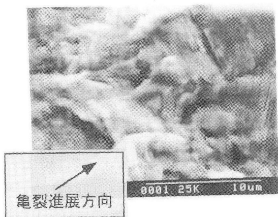
a) 測定点Bのストライエーション
