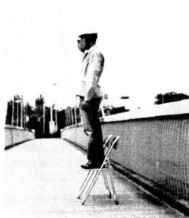
写真-2 人力による衝撃加振試験
