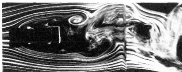
写真-5 ケーブル中心間隔 D=1.5d (アングルなし), 写真-6 ケーブル中心間隔 D=1.5d (アングル有り)
