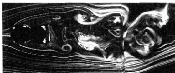
写真-1 ケーブル中心間隔 D=1.0d （アングルなし）、写真-2 ケーブル中心間隔 D=1.0d （アングル有り）
