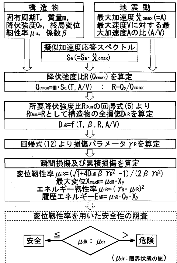
図-3 R_{du} 及びの \gamma_m 回帰式を用いた損傷評価
