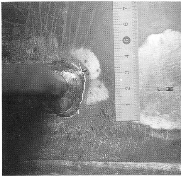
図－5 亀裂進展形状 ( d=1\text{mm} , N=333 万回)
