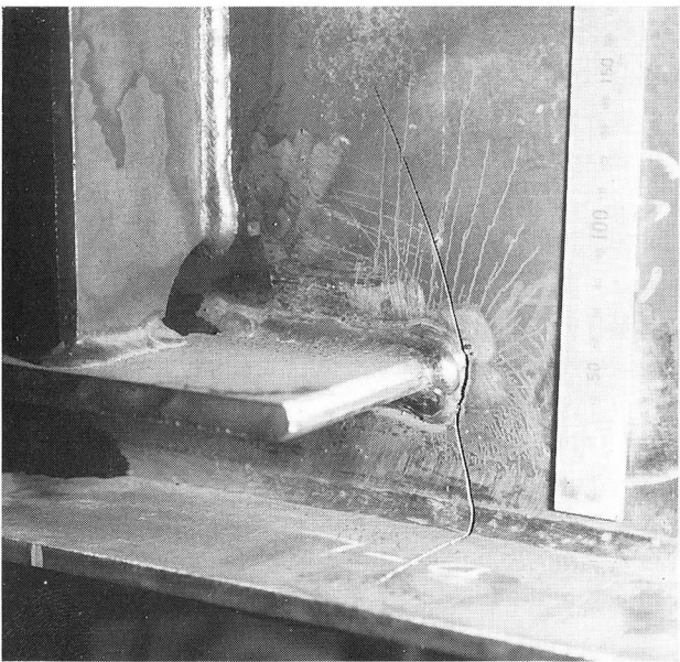
図－6 破断状況 ( d=1\text{mm} , N=519 万回)
