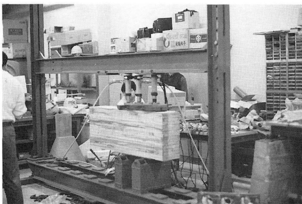
写真-5 純せん断試験
