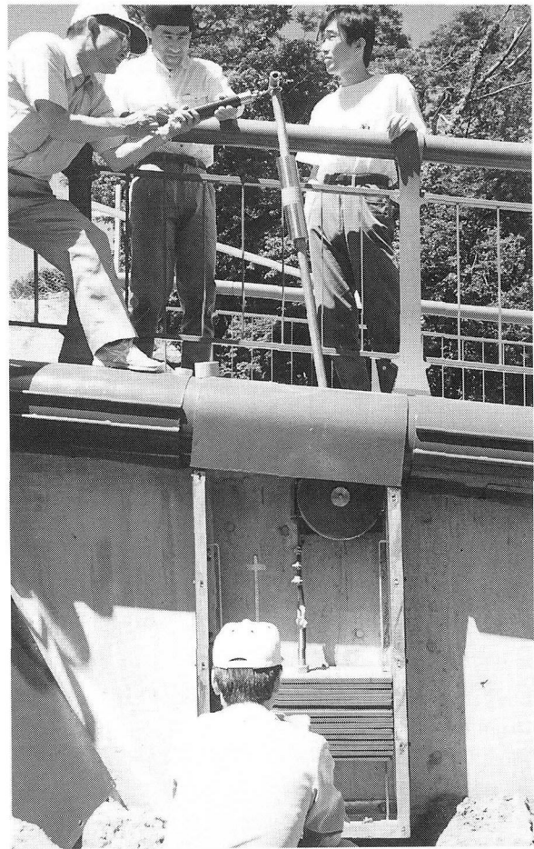
写真-3 サブワイヤのばね定数測定
