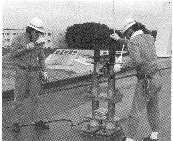
写真-2 重錘落下式衝撃加振試験の状況
