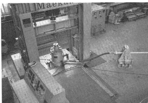
写真-2 増圧ジャッキおよび発射管入口部であった。
