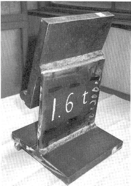
写真－1 首振り試験体の破壊例
