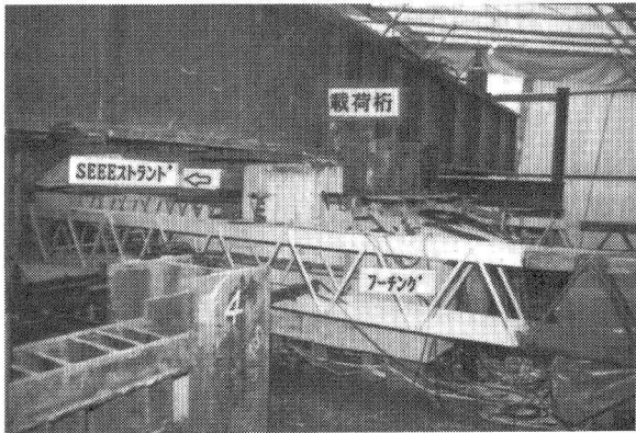
写真・1 群杭の載荷実験状況
