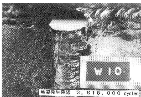
写真-2 ④の初期亀裂の発生状況
