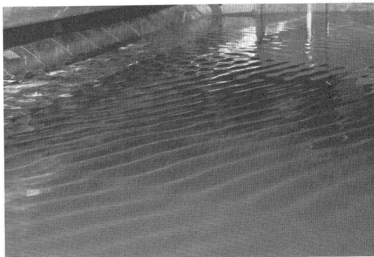
写真-1 振動に伴って 上流面に発生した波
