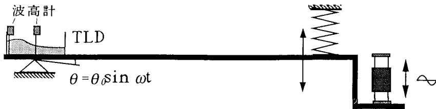
図2 回転加振のための実験装置
