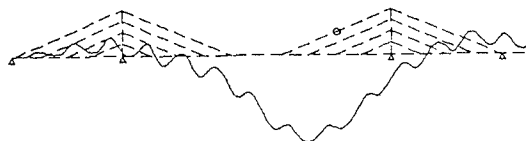
図-7 動的応答曲線（1自由度系車両， 共振車頭間隔を有する荷重列，路面平滑）
