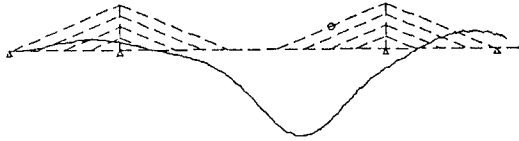
図-8 動的応答曲線（2自由度系車両， L-20相当荷重列，路面凹凸有り）
