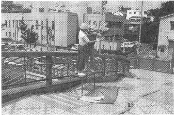
写真－1 砂袋による衝撃加振法の状況
