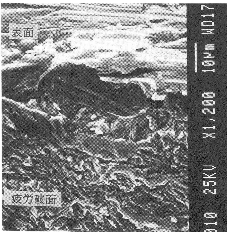
図-13 空気中疲労破面の電子顕微鏡写真 (SM58, Sr=98MPa)
