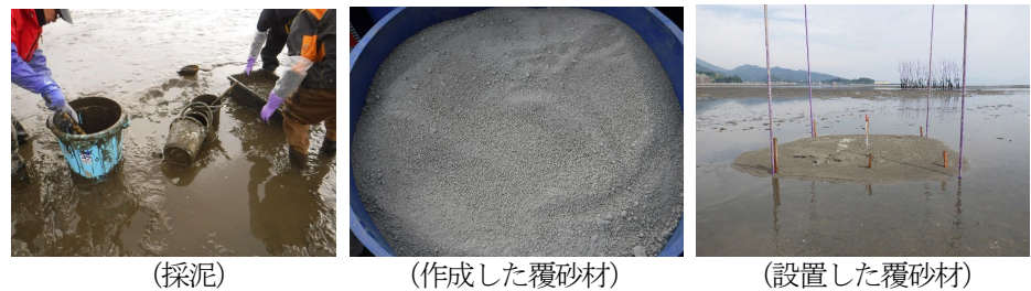
図-1 泥土の採取と実地試験での作成した覆砂材の設置等
