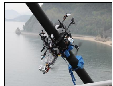
図3 ケーブル点検ロボット 1)
