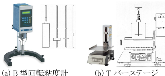
図 2 粘度の経時変化の測定装置
