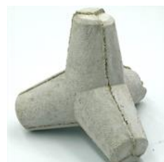
図-2 廃菌床モルタル模型
