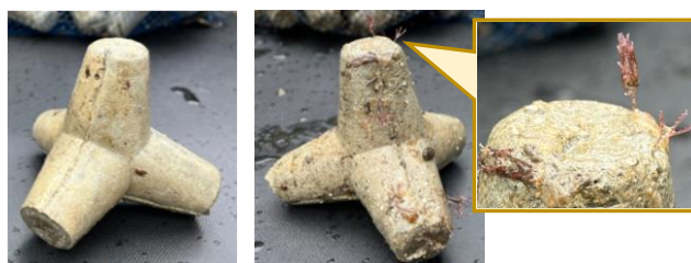
(a) 廃菌床なし (b) 廃菌床添加率 8% (C/W=1.9) 図-6 廃菌床モルタル模型の生物相付着状況 (設置 4 週間)
