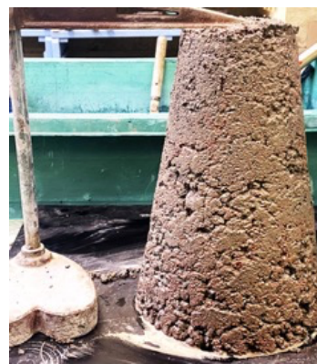
図-3 スランプ試験の状況
