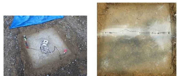
写真-4 弾性波伝播時間の測定様子
