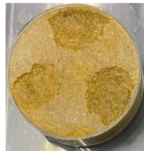
写真-2 3ヶ所集中して養生液を注入した供試体(28日後)
