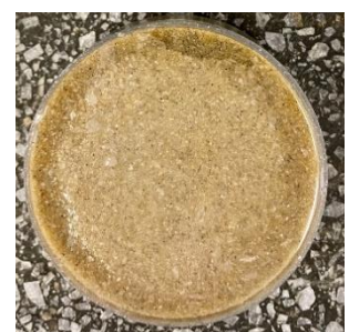
写真-3 縁に沿って養生液を注入した供試体(28日後)
