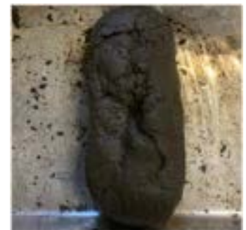
図 3 セメント 300 kg/m 3 混合後 7 日養生した試料
