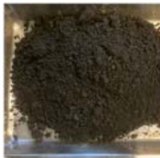
図 4 セメント 100kg/m 3 と炭化物 120kg/m 3 混合後 7 日養生した試料
