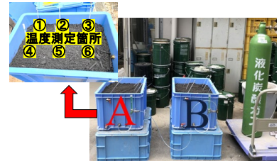
写真-1 炭酸化処理の様子と温度測定
