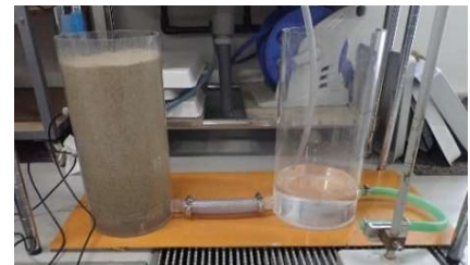
写真-1 土柱法による保水性試験
