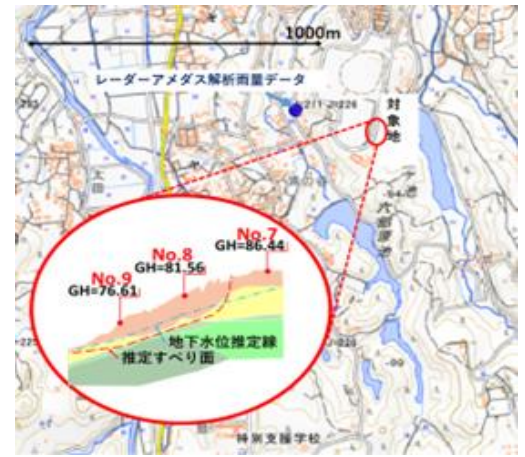
図-1 対象地の地下水位観測地点とレーダーアメダス解析雨量のデータを用いた地点
