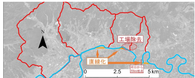
図-4 六角川蛇行部直線化
