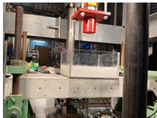
写真 3 重錘落下実験の状況
