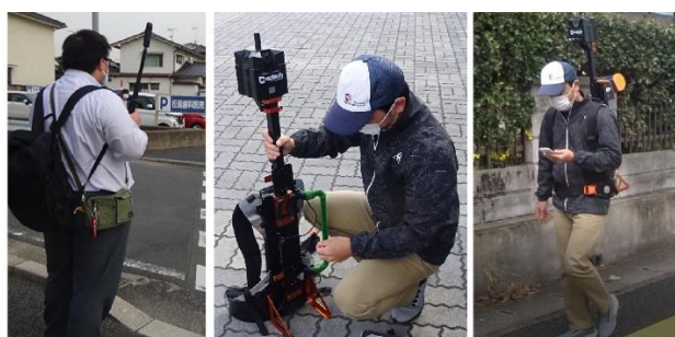
写真2 360°カメラとGEOSLAMの計測状況
