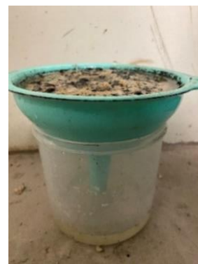
図 3 漏斗を用いた試料の保水方法
