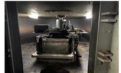
写真1 中型遠心力載荷装置
