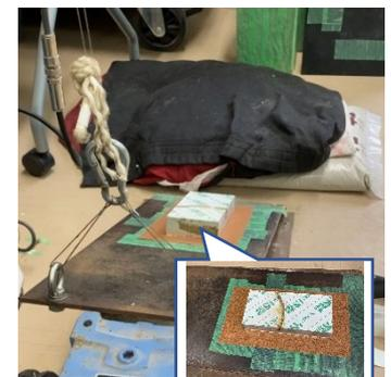
写真2 摩擦係数計測の様子
