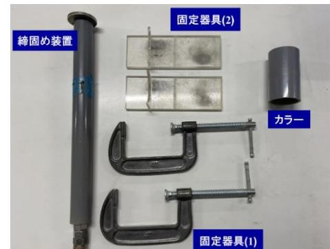
写真-2 締固め装置
