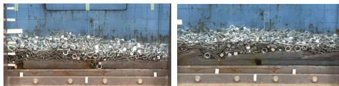
写真-8 沈設物の堆積状況(混合・水平)
