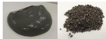
図 1 浚渫土(左)と改質材(右)
