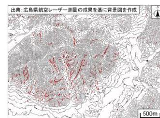
図-7 CNN モデルに未学習のテストデータを適用した場合の予測結果
