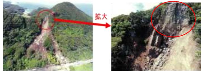
図-1 斜面崩壊による不安定岩塊の残存状況
