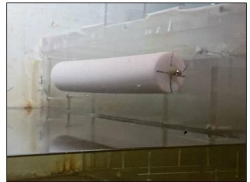
図-1 係留式越波対策工の模型
