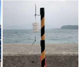
写真-3 飛来塩分捕捉器
