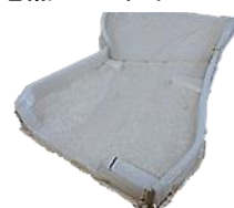
図-3 地点1の模型(水平・鉛直ともに1/250)
