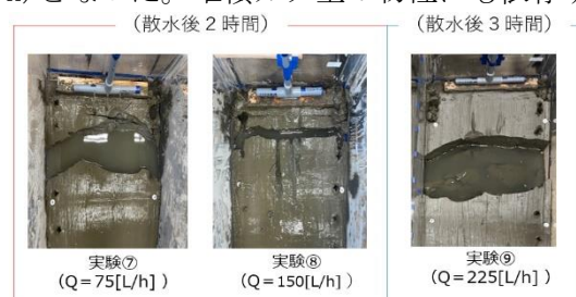
写1 ガタ土が破断したケース(実験⑦～⑨)
