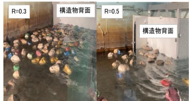
図 6 構造物背面における軽石の移動
