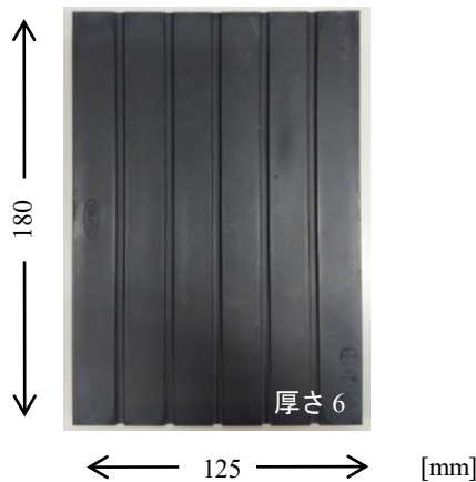
写真-1 在来線 PC まくらぎ用標準仕様の軌道パッド
